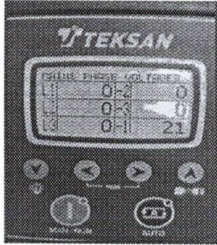
**Imagen N°5:** Equipo no entrega tensión a la salida del alimentador. Posiblemente tenga algun problema en la etapa de generador (tarjeta de salida)
